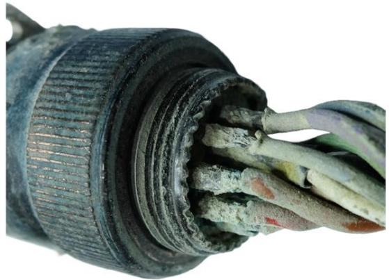
CABLES ROTOS Y CONECTORES SULFATADOS
