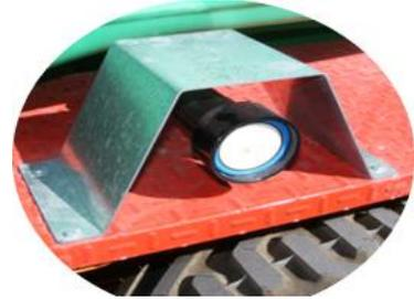
Fig. 20 – Montaje en guardabarros
