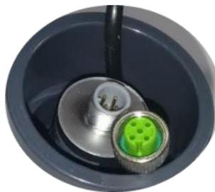
Fig. 19 – CONEXIÓN M12.
