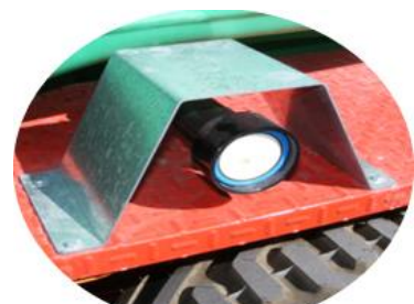
Fig. 19 - Montaje en guardabarros
