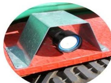
Fig. 9 – Montaje en guardabarros
