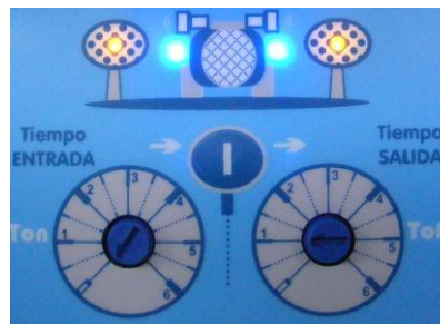
Fig. 1 – Regulación de retardos y pilotos de funcionamiento.
